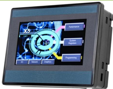
CONTROLADOR X5 REGISTRO DE DATOS, ALARMAS REMOTAS VIA EMAIL, VISUALIZACION DE DATOS POR ETHERNET Y EXTRACCIÓN DE DATOS VÍA USB.
